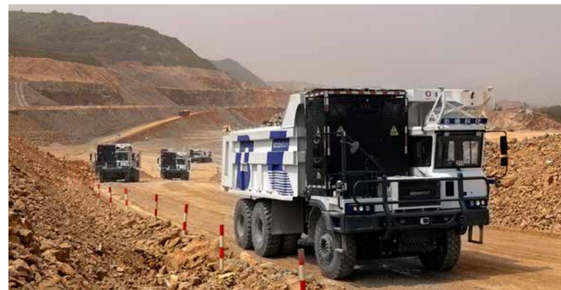
胡心怡带领团队以科技创新为支撑，打造了一个包含行业领先的 L4 级自动驾驶系统、车辆线控系统、5G 远程控制系统及云端智能调度系统在内的露天矿山智能作业平台，可以实现矿车、挖机、装载机等矿用工程机械的互联互通和集群化智能作业。伯镭科技自建车辆线控团队，通过采用冗余控制器、冗余 CAN 总线、冗余转向、冗余制动、冗余油门、自动排水等功能安全措施及控制策略，实现了适度低成本的无人驾驶矿卡功能安全；基于此技术，无人驾驶矿车实现了类似航空安全的故障操作性能，即使产品出现故障，也能进入受控的安全运行模式，实现了对驾驶员的零依赖。伯镭科技发布的无人矿卡不设置安全员，让没有驾驶室理想成为现实，在矿区实现真正意义上的无人驾驶。
